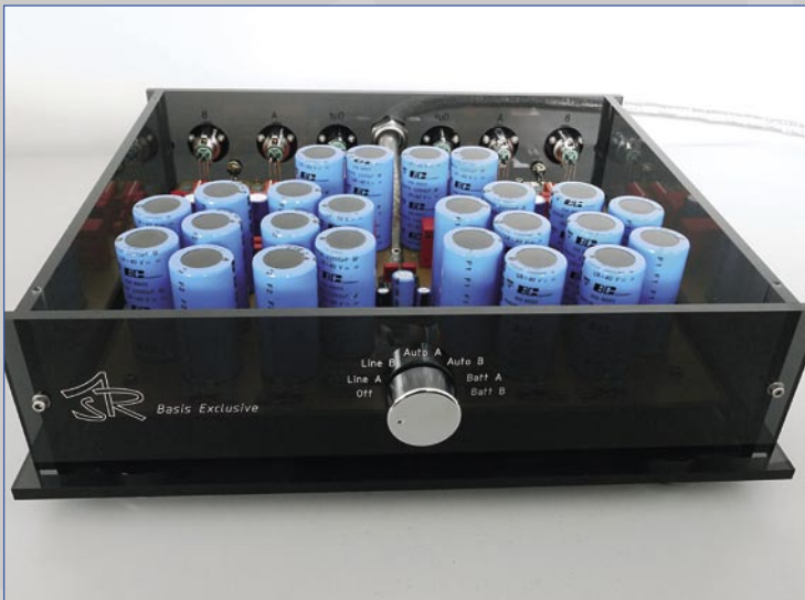
ASR Audiosysteme Basis Exclusive HV mit hoher Siebkapazität
