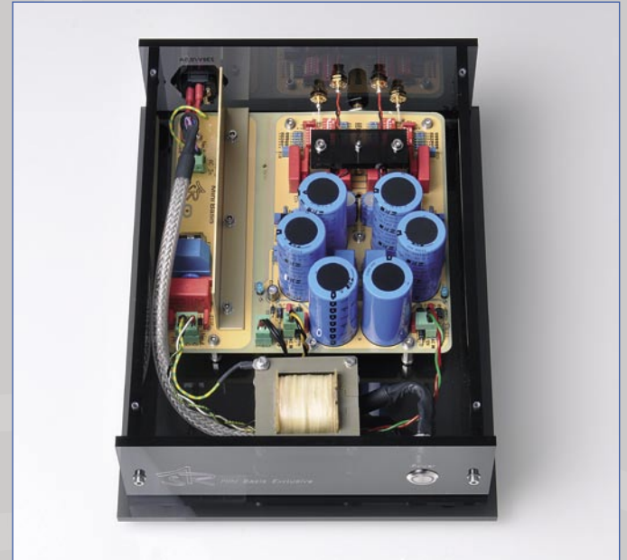
ASR Audiosysteme Mini Basis Exclusive HV - optional lieferbar mit symmetrischem Ausgang und WBT™ Nextgen Buchsen in Kupfer oder Silber
