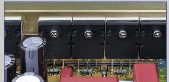
Die Leistungstransistoren mit Keramikisolatoren und massiver Messingschiene.
